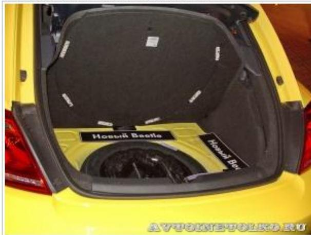
Запасное колесо расположено горизонтально под багажником в специальной нише с крышкой.
