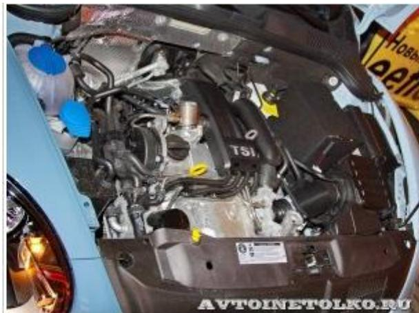
В стандартной комплектации автомобиль представлен с двигателем 1.2 TSI мощностью 105 л.с. в сочетании с 6-ступенчатой МКПП или 7-ступенчатой DSG на выбор. Для версий Beetle Design и Beetle Sport также предлагается бензиновый мотор объемом 1,4 л (160 л.с.) с 6-ступенчатой механической коробкой передач или 7-ступенчатой коробкой DSG.
